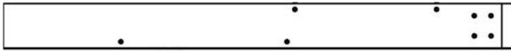
D1 (x2) | EXTRÉMITÉ DE SOLIVE - A4M01464 1 3/8 po X 5 1/4 po X 59 7/8 po (36 x 134 x 1521)
